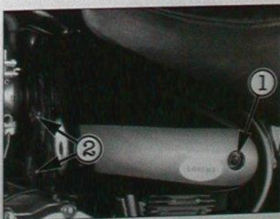
Bild 15 Linker Seitendeckel 1 Befestigungsschraube 2 Haltestifte
