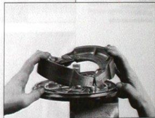
Bild 256 Bremsbacken einklappen
