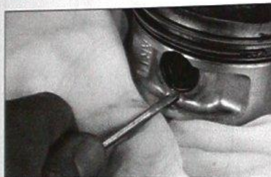
Bild 179 Sicherungsringe des Kolbenbolzens aushebeln
