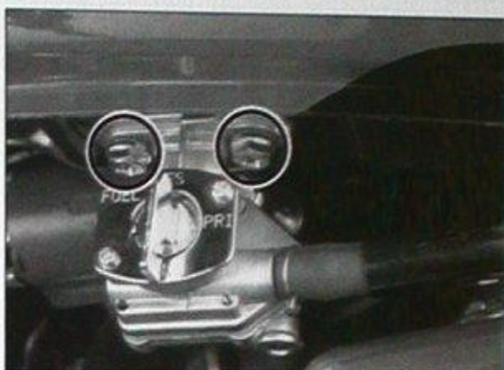
Bild 13 Benzinhahn-Befestigungsschrauben
