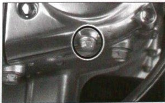
Bild 22 Kühlmittel-Ablass
