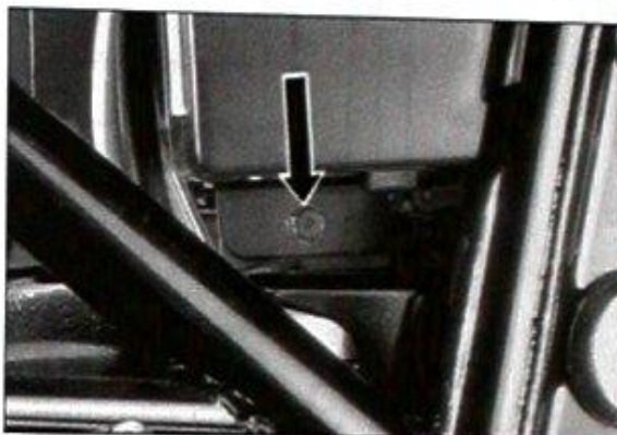
Bild 108 Pfeil = Befestigungsschraube der Zündboxhalterung
