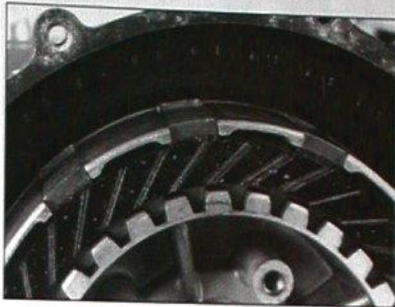
Bild 147 Nuten der Reibscheiben weisen nach rechts
