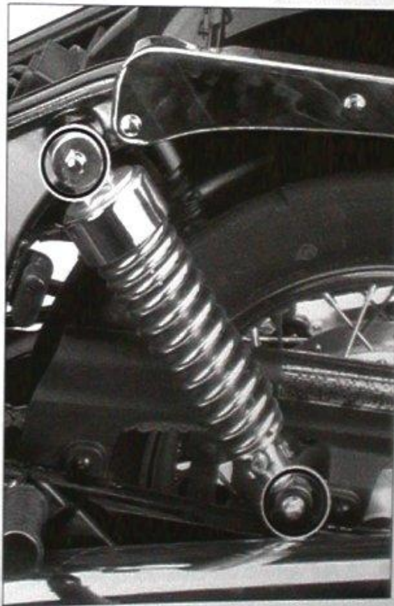
Bild 281 Federbein-Befestigung
