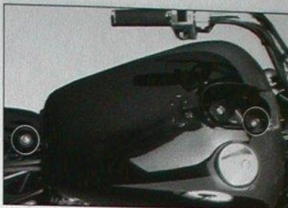
Bild 12 Tankbefestigungsschrauben
