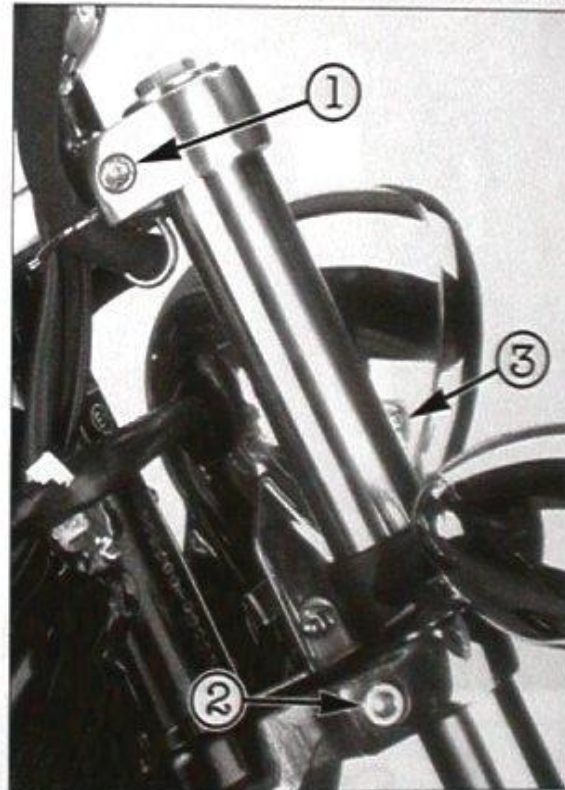
Bild 68 1 Obere Gabelklemmschraube 2 Untere Gabelklemmschraube 3 Lampenring-Befestigung
