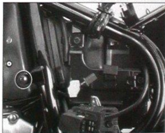
Bild 100 Kreis = Befestigungsschraube des Luftfiltergehäuses
